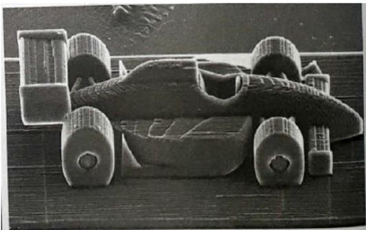
A escultura apresentada é uma miniatura de um carro de Fórmula 1, com 100 micrômetros de comprimento. Um micrômetro é a milionésima parte de um metro.
