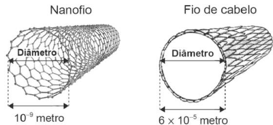
O número que expressa a razão existente entre o comprimento do diâmetro de um fio de cabelo e o de um nanofio é
