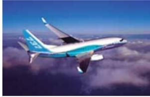
Tomando como base um Boeing 737-800, seus tanques de combustível podem comportar até 21 t (21 toneladas) de querosene de aviação (QAV).
